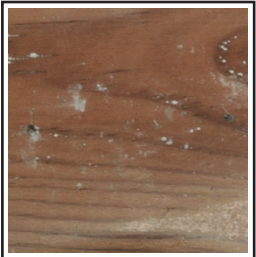
Surface mould/Moho superficial/ Moisissures superficielles/ Oberflächlicher moder/Muf fa su- perficiale/Oppervlakte-schimmel/ Bolor superficial
